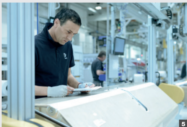
4. Montage der letzten Anbauteile ■ 5. Konzentrierte Prüfung der Oberfläche kurz vor der Auslieferung der Bins ■ 6. Die fertigen Gepäckfächer stehen zur Verpackung und Auslieferung bereit.
