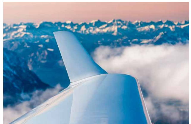
Winglets reduzieren Verwirbelungen an den Flügelspitzen und ermöglichen so effizienteres Fliegen.
